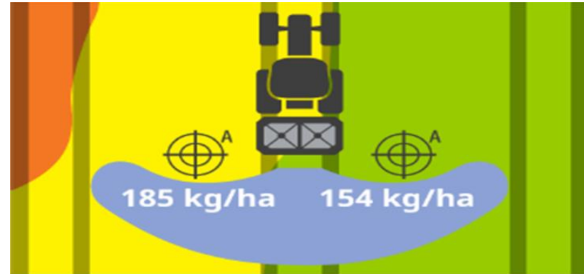
Zwei Control Point für jedes Dosierorgan einzeln Mitte zwischen den Fahrgassen
