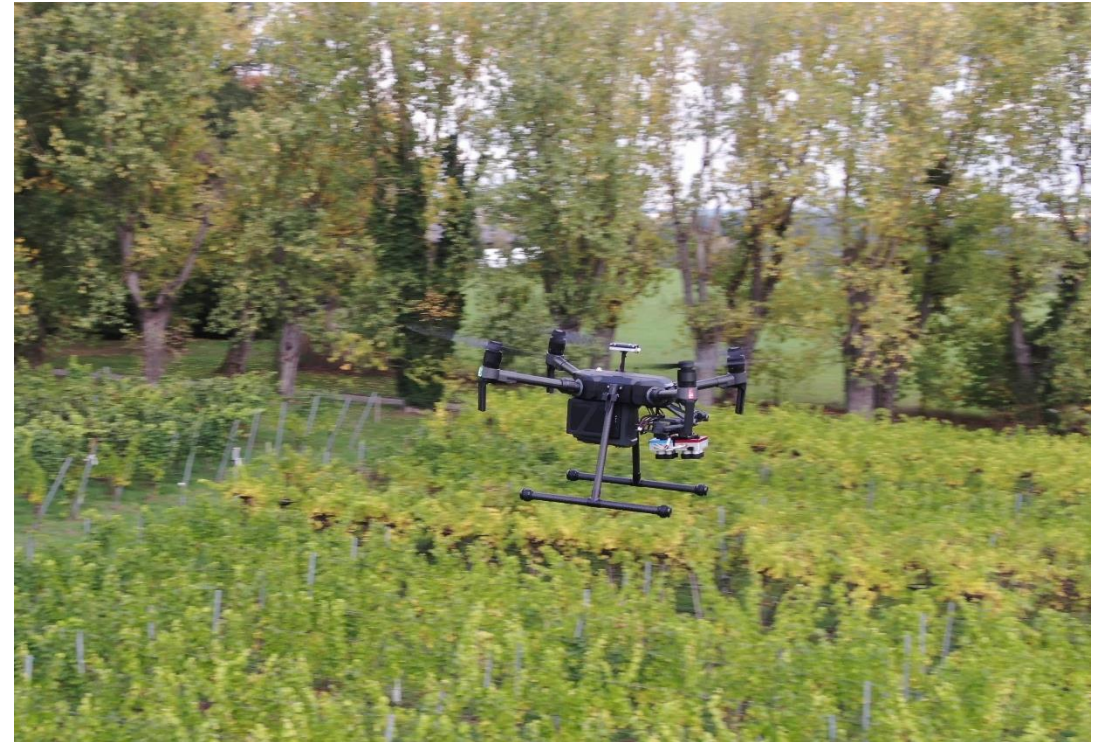
Matrice 210 V2 mit angebautem Micasense Dual Camera System während eines Messflugs in einem Weinberg im Herbst 2020
